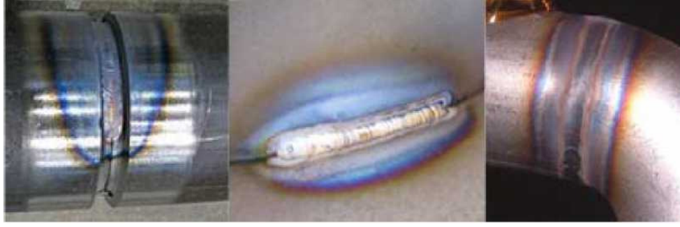
Resim 1) Kaynakli birleşimde ısıdan etkilenme bölgeleri
