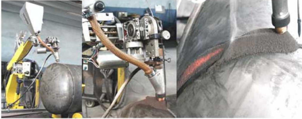
Resim 11. Dairesel kesitlerin tozaltı kaynağı uygulaması
